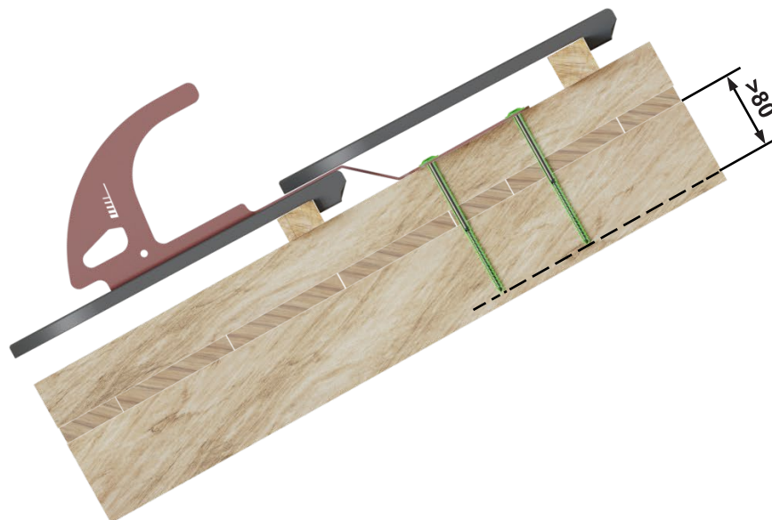
Bild: RICHTIG Positionierung des Dachhakens gegenüber untenliegendem Ziegel: → soll Bündig zum Ziegel sein
